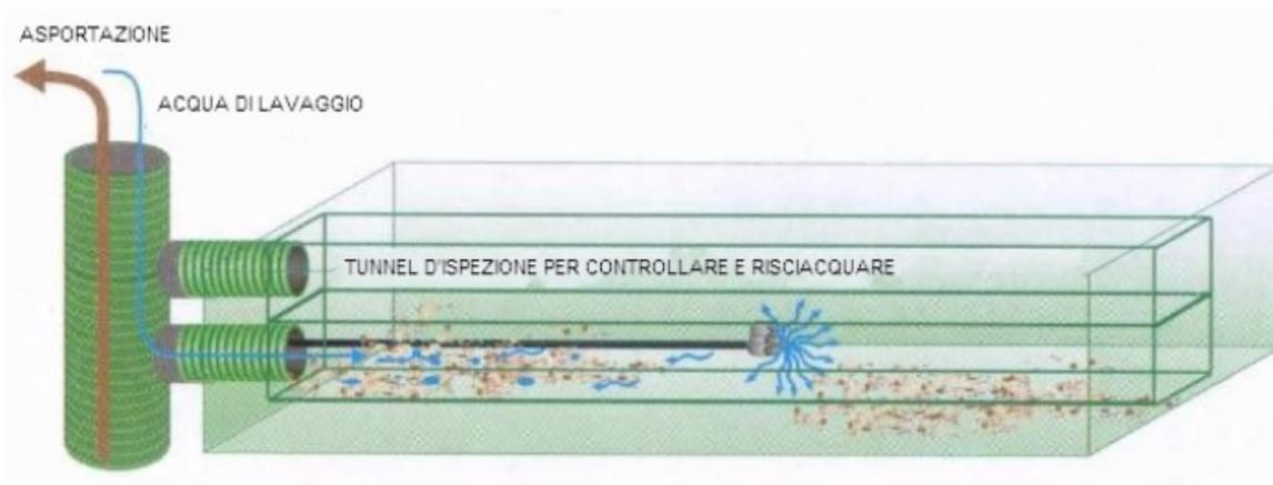
Per la pulizia con sonda spray si consiglia l'utilizzo di un ugello rotante a 90° con getto d'acqua a 45°.
