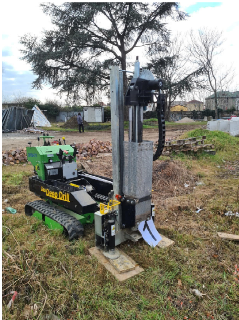
Figura 3: esecuzione della prova penetrometrica P1
