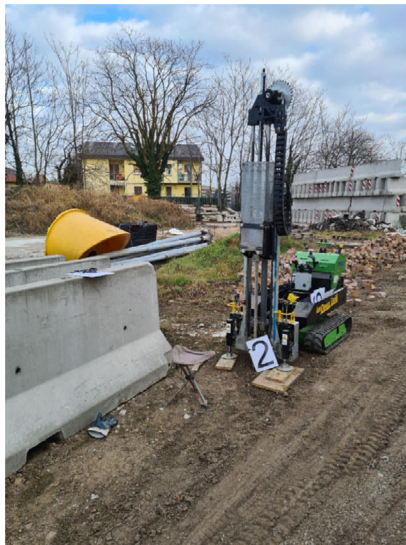
Figura 4: esecuzione della prova penetrometrica P2
