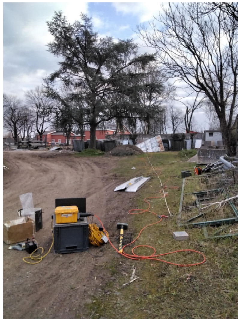
Figura 6: esecuzione indagine sismica MASW
