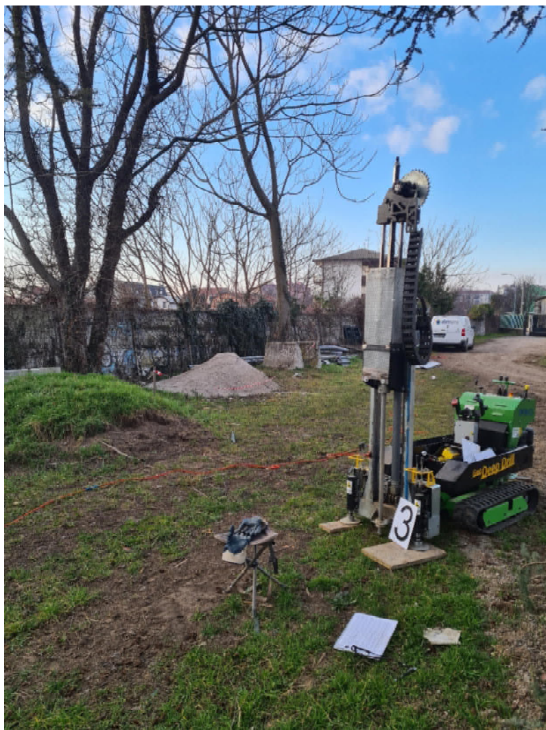
Figura 5: esecuzione della prova penetrometrica P3
