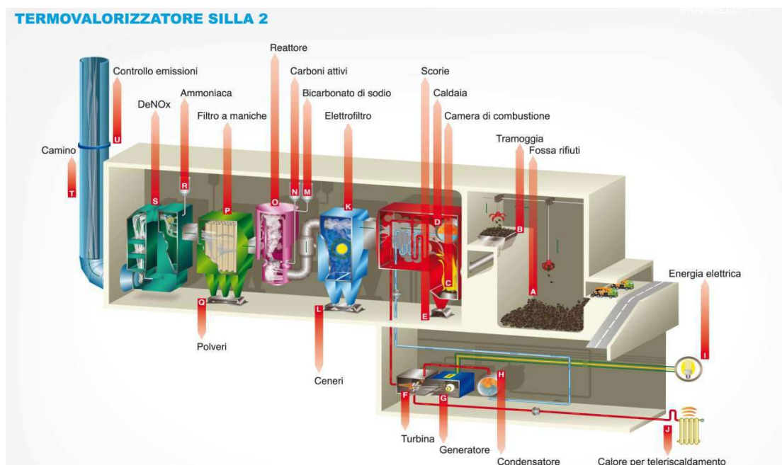
Figura – Sezioni principali dell'impianto (A2A ambiente)
