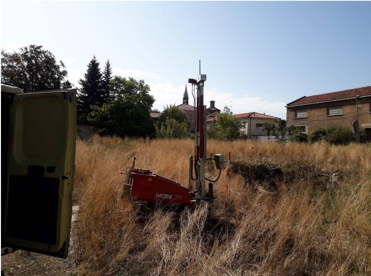
Fig.9. Prova penetrometrica SCPT08 (0-5,6 m).
