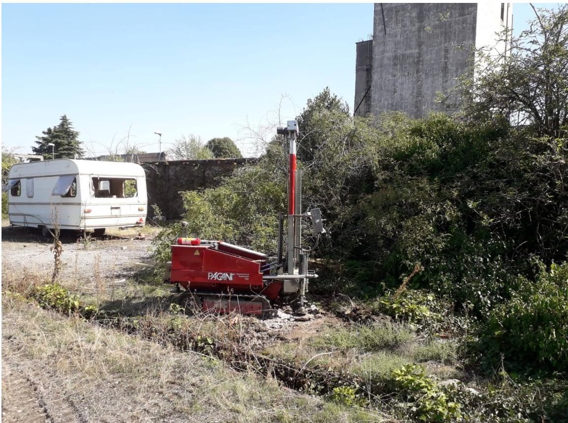
Fig.10. Prova penetrometrica SCPT09 (0-5,8 m).
