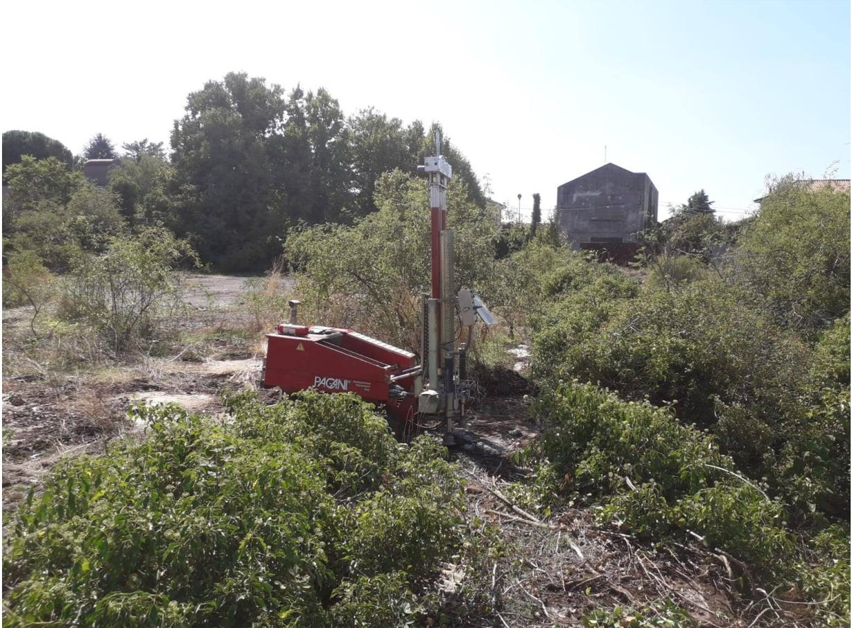
Fig.13. Prova penetrometrica SCPT12 (0-5,6 m).
