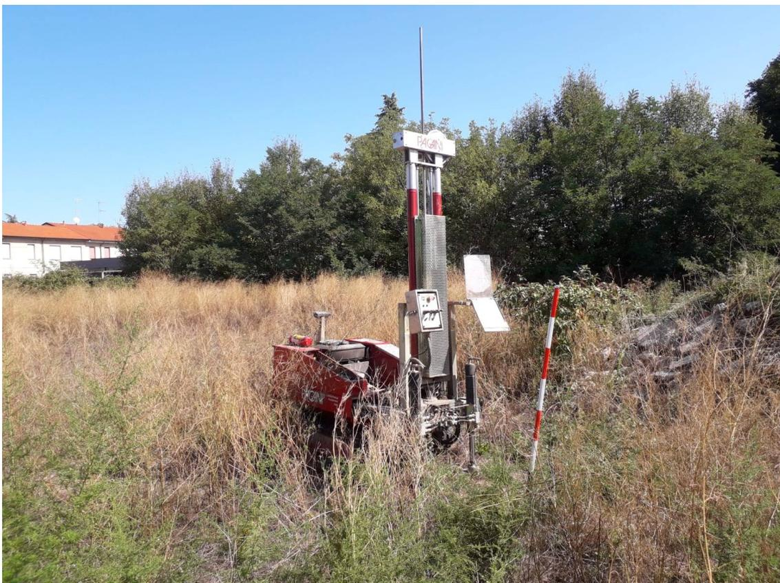
Fig.4. Prova penetrometrica SCPT03 (0-6,2 m).
