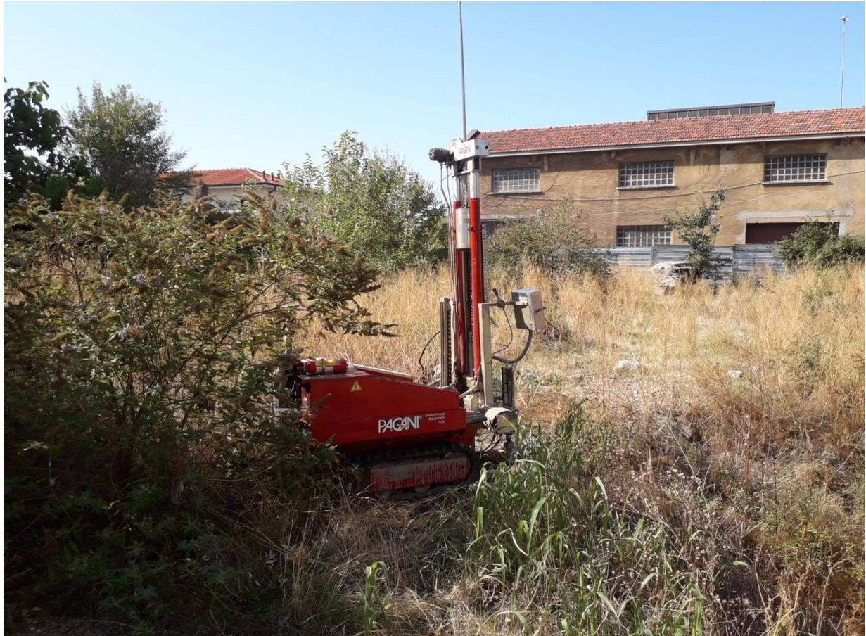
Fig.8. Prova penetrometrica SCPT07 (0-4,8 m).
