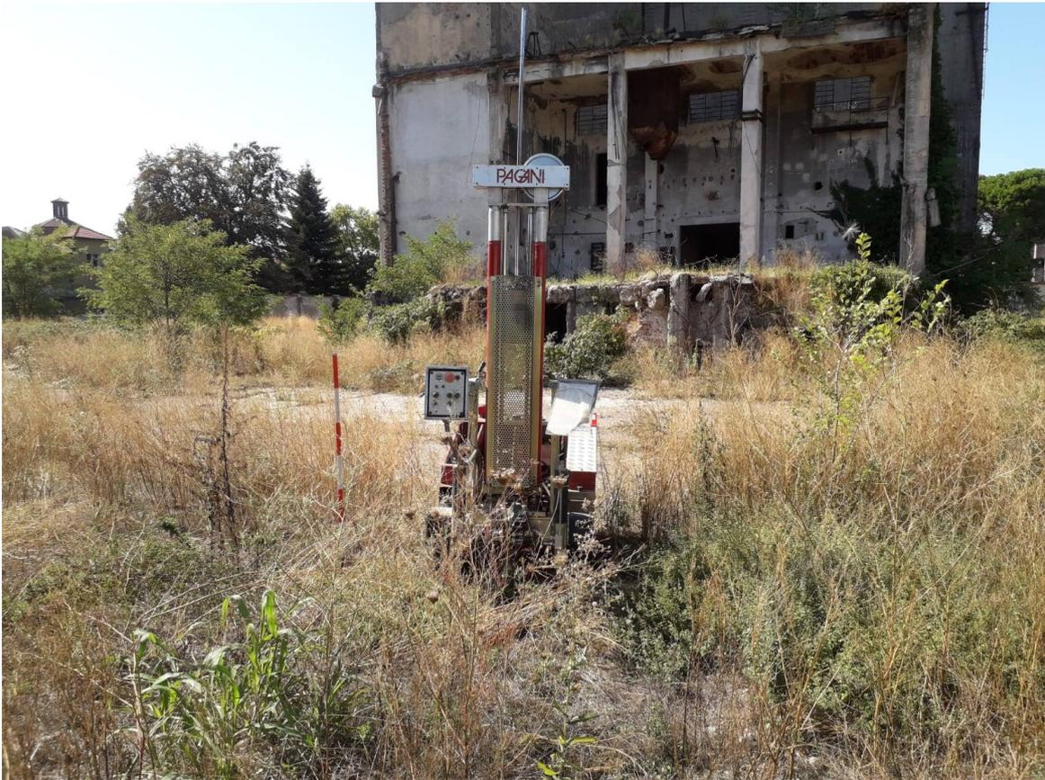
Fig.3. Prova penetrometrica SCPT02 (0-4,8 m).
