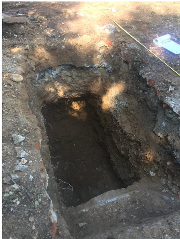
Fig.26. Pozzetto geognostico C6.
