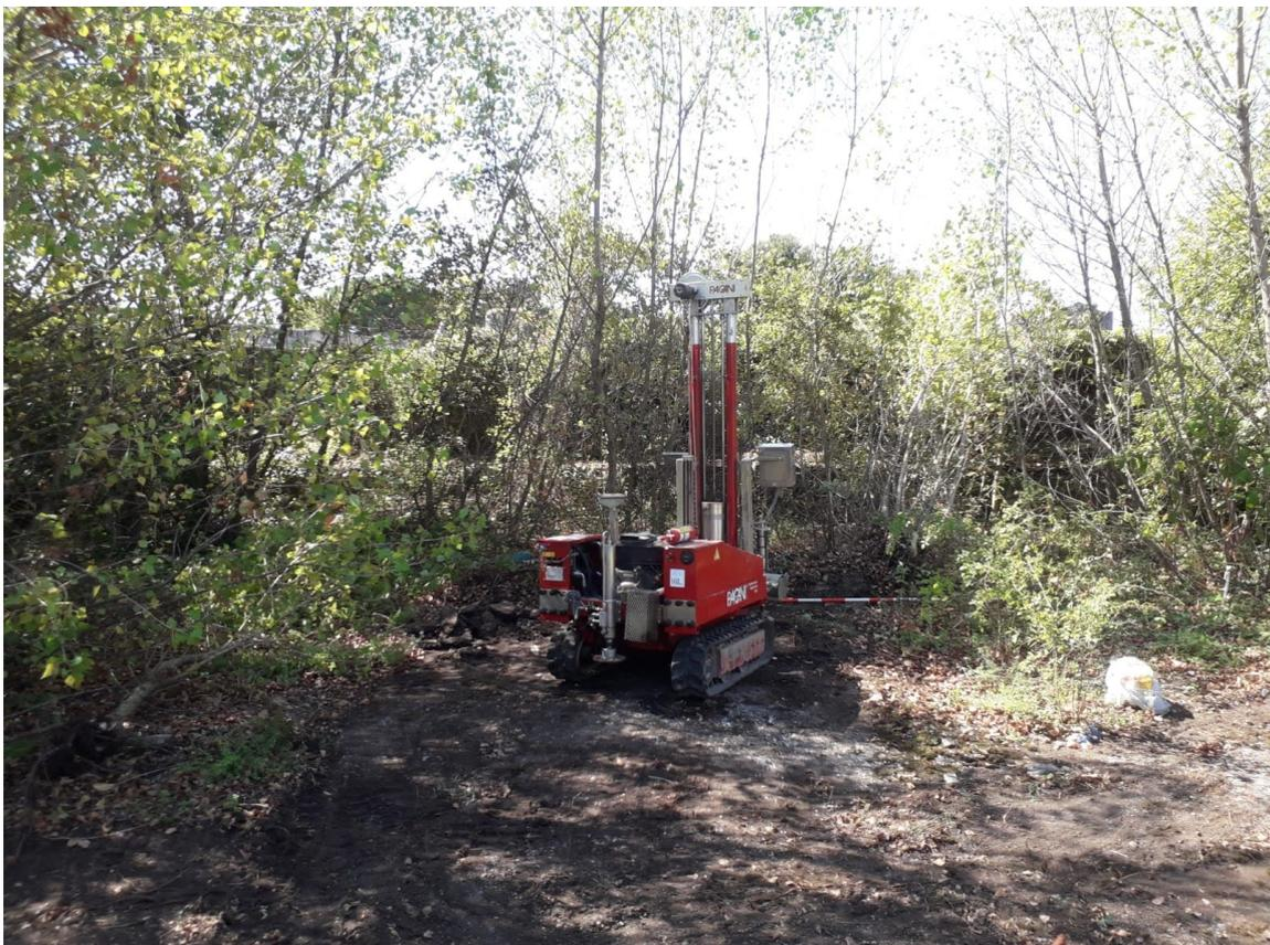
Fig.16. Prova penetrometrica SCPT15 (0-3,4 m).
