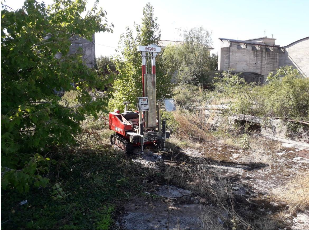
Fig.11. Prova penetrometrica SCPT10 (0-6,4 m).
