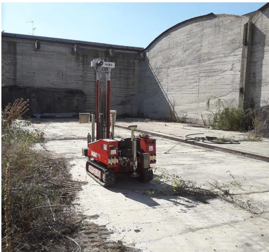
Fig.12. Prova penetrometrica SCPT11 (0-5,8 m).
