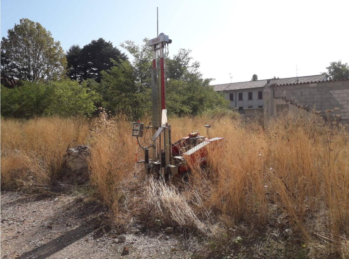
Fig.7. Prova penetrometrica SCPT06 (0-6 m).
