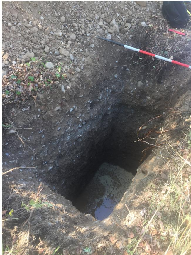
Fig.27. Pozzetto geognostico C7.
