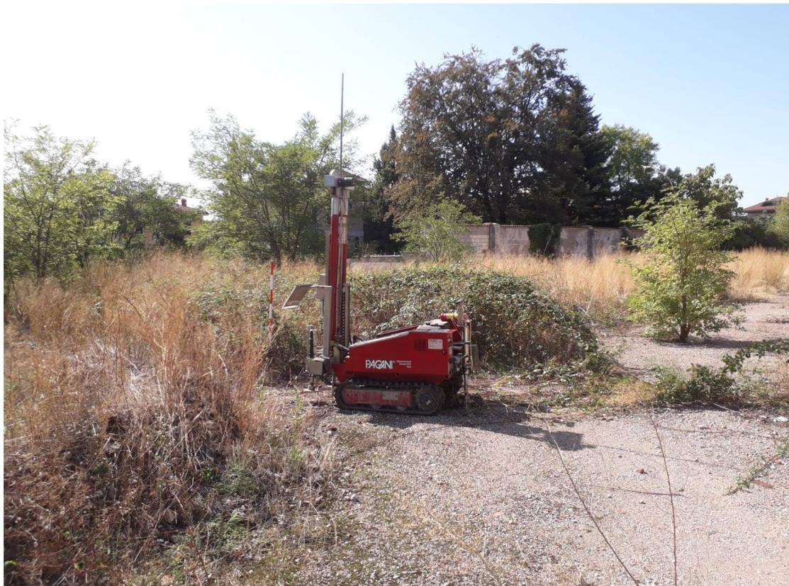
Fig.6. Prova penetrometrica SCPT05 (0-5,8 m).
