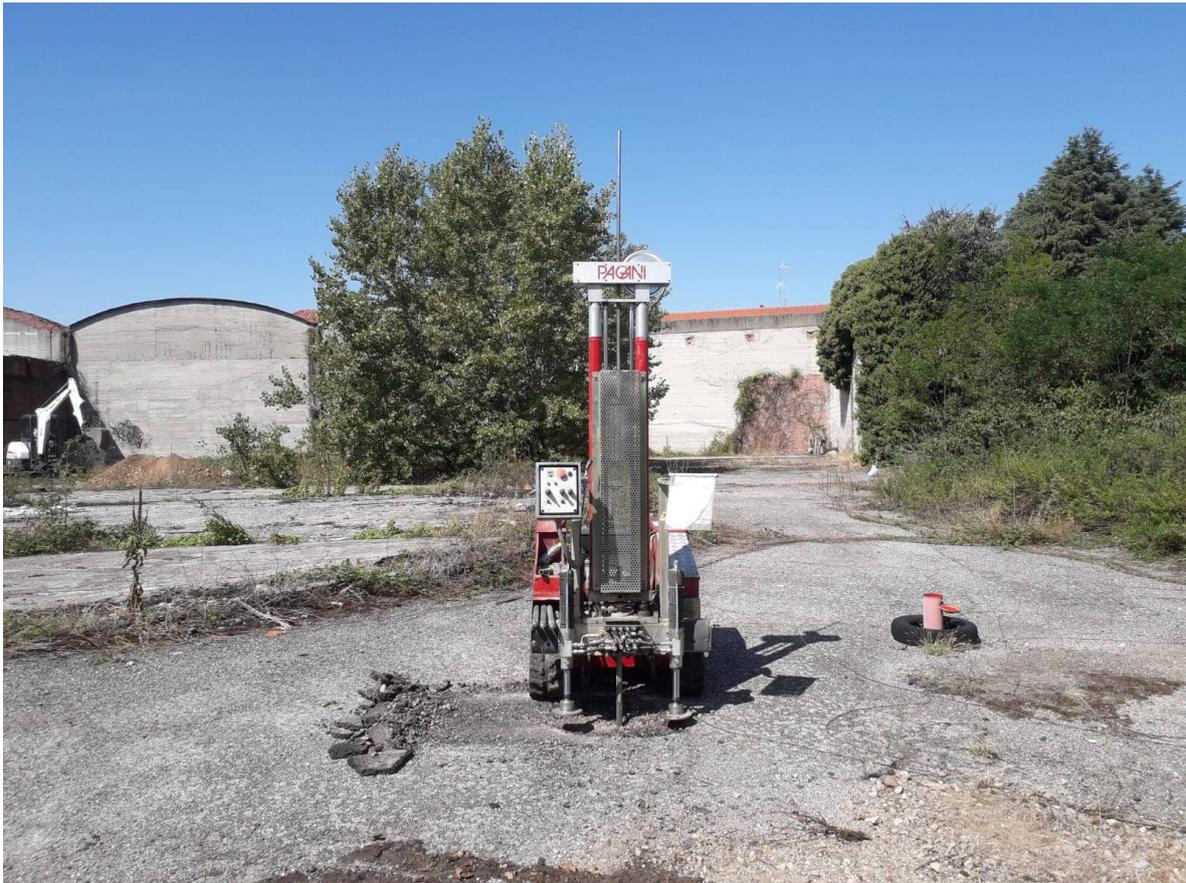
Fig.15. Prova penetrometrica SCPT14 (0-5,4 m).
