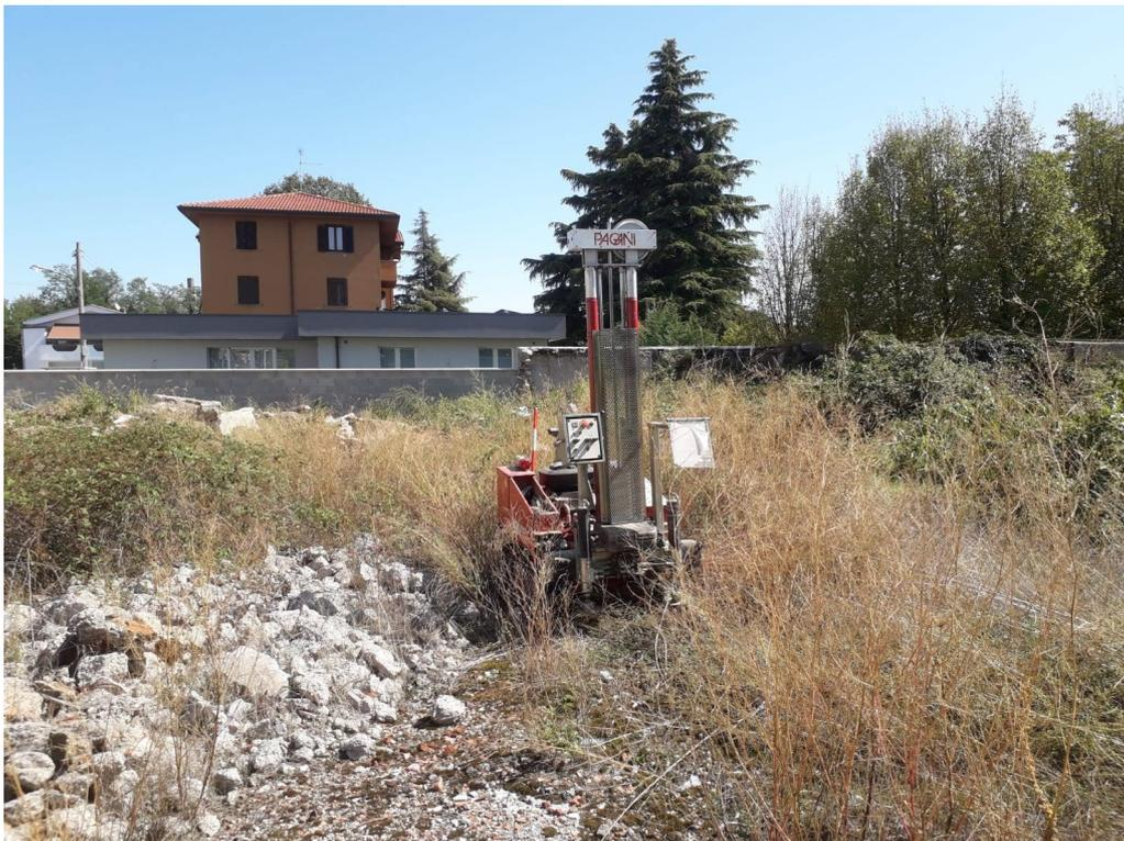
Fig.2. Prova penetrometrica SCPT01 (0-6,6 m).
