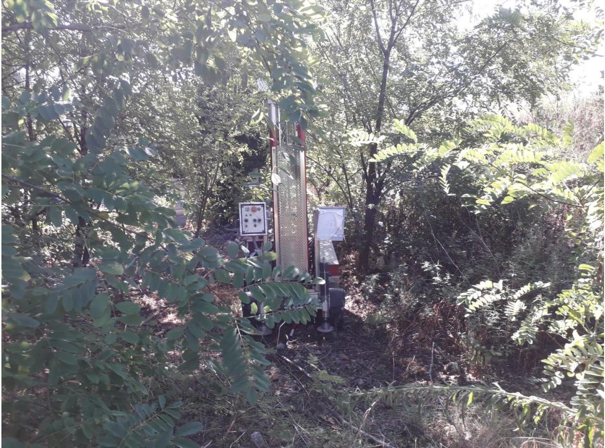
Fig.5. Prova penetrometrica SCPT04 (0-6,4 m).
