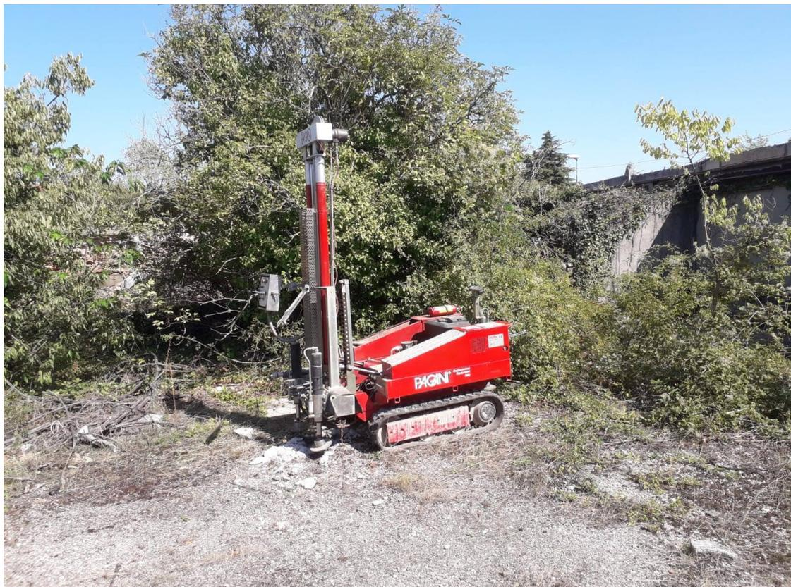
Fig.14. Prova penetrometrica SCPT13 (0-6 m).
