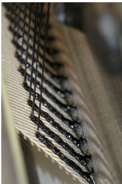
Il tessuto di vetro è impregnato di resina sintetica liquida e termoindurente
