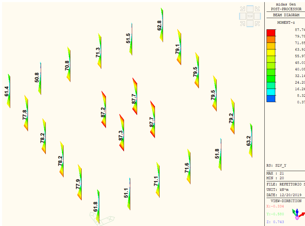
Figura 163 - Sollecitazioni flettenti nei pilastri comb. SLV_Y ( M_{z,max} = 88 \text{ kNm} )
