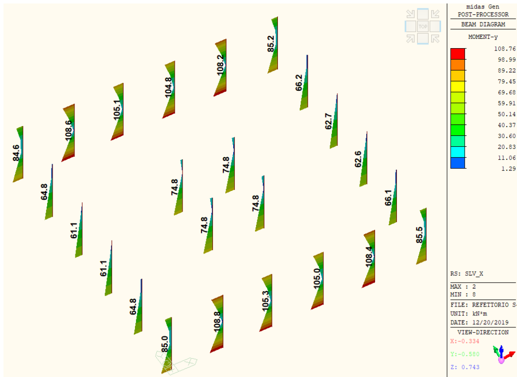
Figura 161 - Sollecitazioni flettenti nei pilastri comb. SLV_X ( M_{y\_max} = 109 \text{ kNm} )
