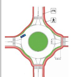
continuità dei percorsi ciclo-pedonali è garantita da appositi attraversamenti posti ad una distanza di 5 metri dalle linee di arresto. La sicurezza è garantita dall'utilizzo di una separazione fisica (ad esempio un'aiuola) e dall'andamento tangente percorsi ciclo-pedonali alla rotatoria che favorisce un buon grado di visibilità tra veicoli e biciclette/pedoni.
