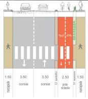
Ad unico o doppio senso di marcia, sono in sede propria quelle piste ciclabili la cui sede è separata fisicamente da quella relativa ai veicoli a motore ed ai pedoni attraverso idoneo spartitraffico longitudinale, fisicamente invalicabile, di larghezza minima pari a 0,5 m.
