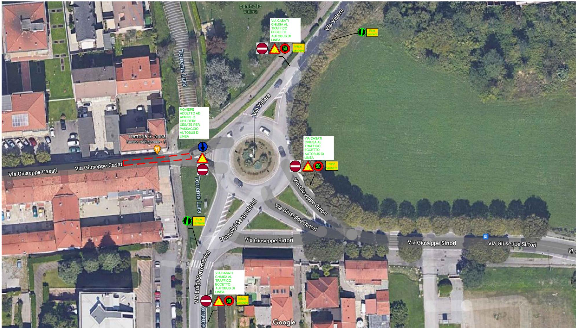
LAYOUT DI CANTIERE: CANTIERIZZAZIONE TIPOLOGICA SULLA TRATTA VIA SETTEMBRINI VERSO VIA CASATI. I MOVIERI VERRANNO UTILIZZATI PER APRIRE E CHIUDERE LE CESATE DI VIA CASATI PER CONSENTIRE IL PASSAGGIO DEGLI AUTOBUS DI LINEA.
